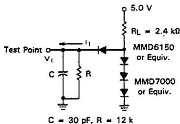
FIGURE 4 — CMOS EQUIVALENT TEST LOAD
