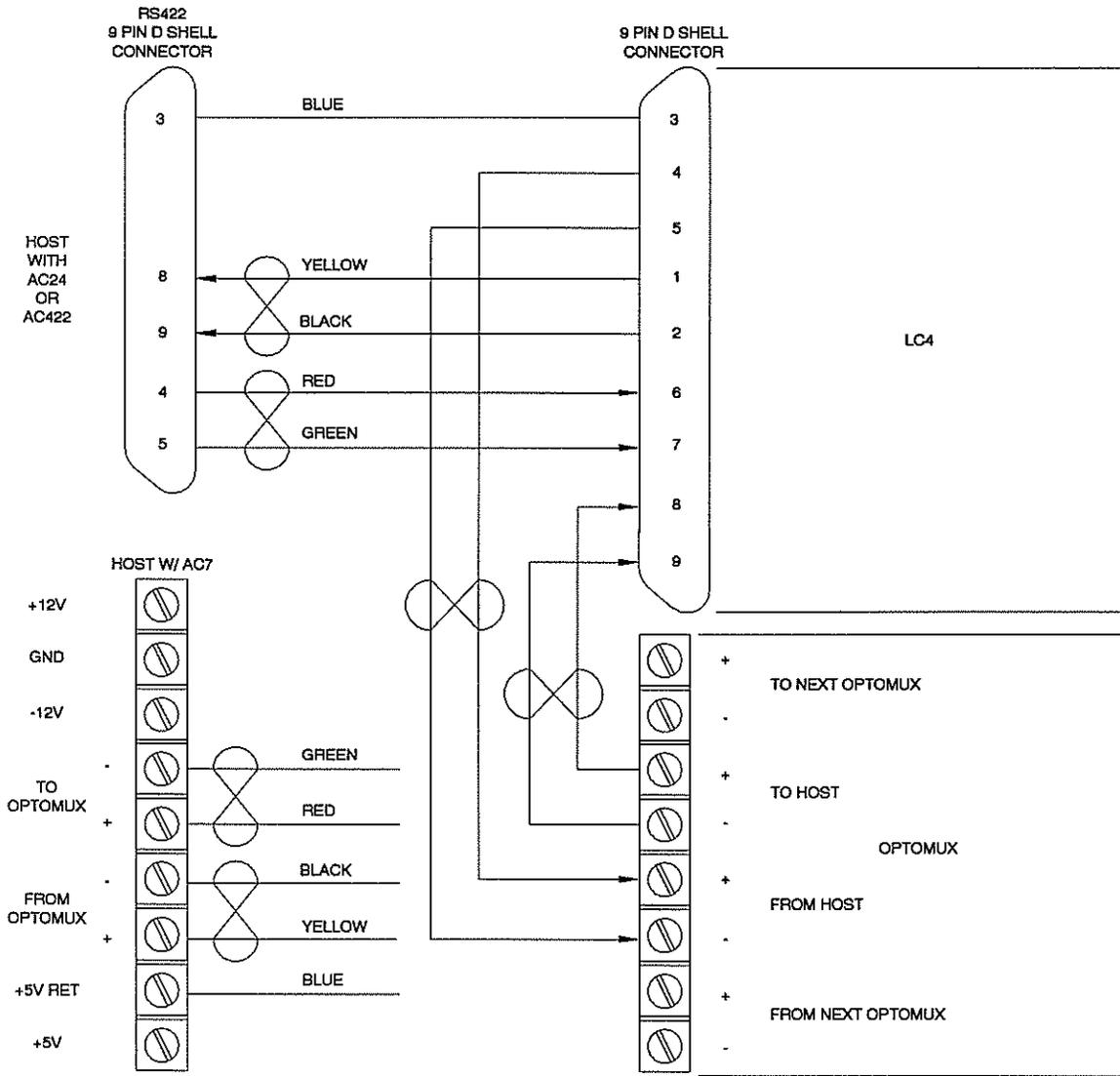
Figure 5 - Wiring Using D-Shell
